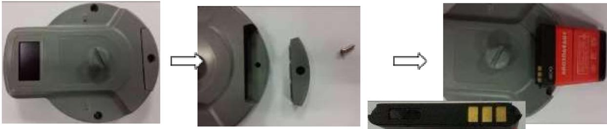
[Note]: Insérer l'extrémité avec les électrodes en premier.
