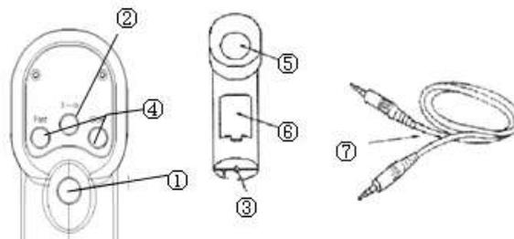
Fig. 7-1 Appareil de stimulation et câble
