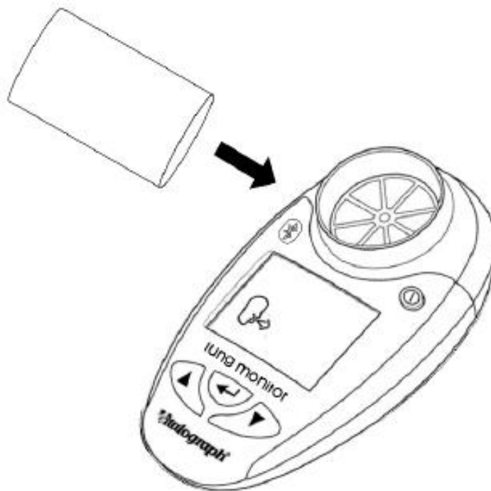
Figure 2. Embout buccal inséré dans la tête de mesure du débit
